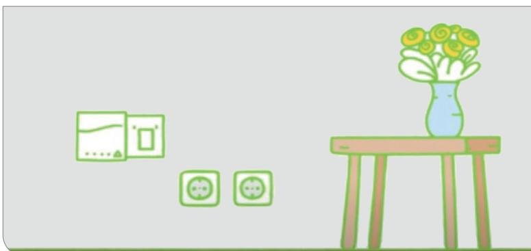
Im Wohnraum wird die Glasfaseranschlussdose montiert und 2 Steckdosen sollten in unmittelbarer Nähe sein. Endmontage erfolgt durch das Technik-Team der Energie Steiermark Breitband GmbH.
