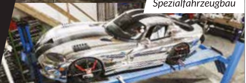
Achs-/ Radlastvermessungen & Fahrwerksabstimmungen
