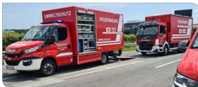
Das Ölschadensfahrzeug in Verbindung mit dem LKW und dem Ölsperren-Anhänger bildet unsere Ölschadens-Einheit, die im Bedarfsfall durch ein Mannschafts-transportfahrzeug ergänzt wird.
